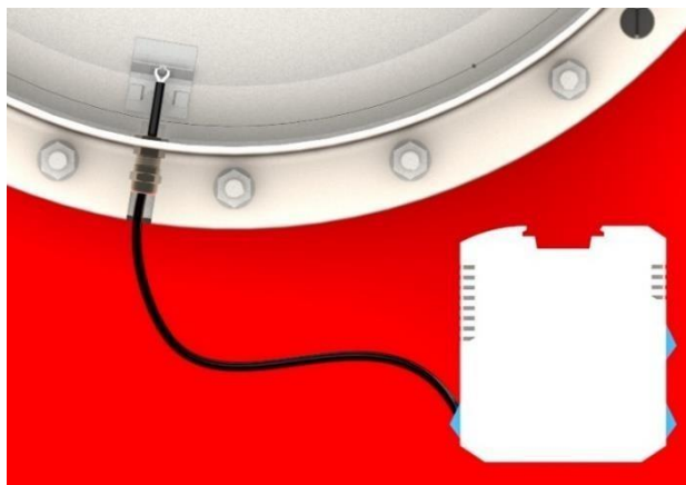
Рис. 52 – Подключение индикатора открытия VMP
