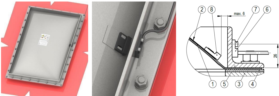
Рис. 45 – Установка сенсора индикатора G2 на раму
