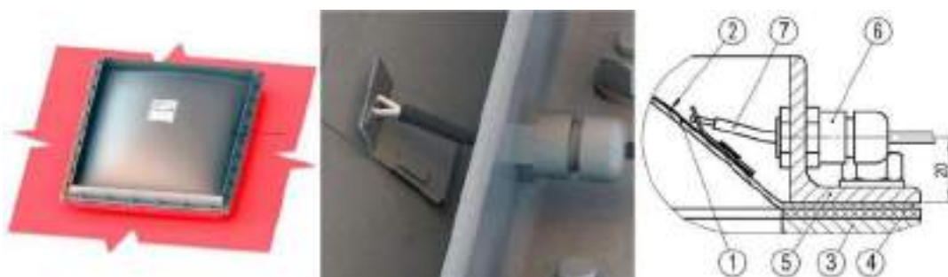
Рис. 41 – Установка кабеля индикатора G1 в проход в L-образный профиль
