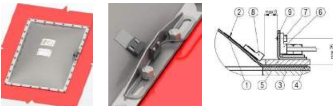
Рис. 44 – Установка сенсора индикатора G2 на держатель
