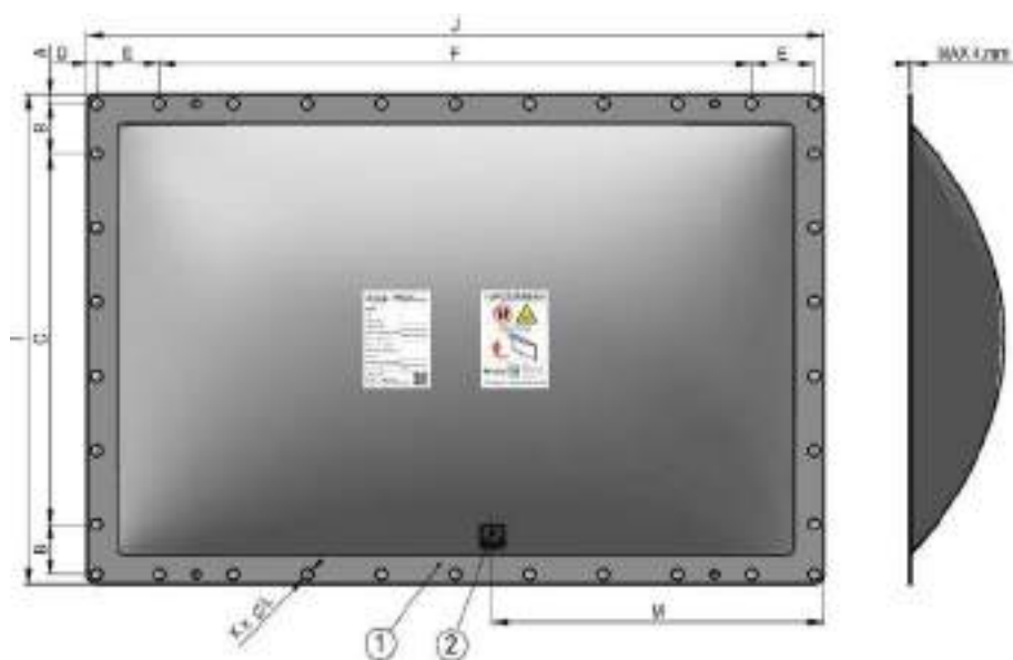
Рис. 25 – Габаритная схема для VMP тип SU прямоугольного
