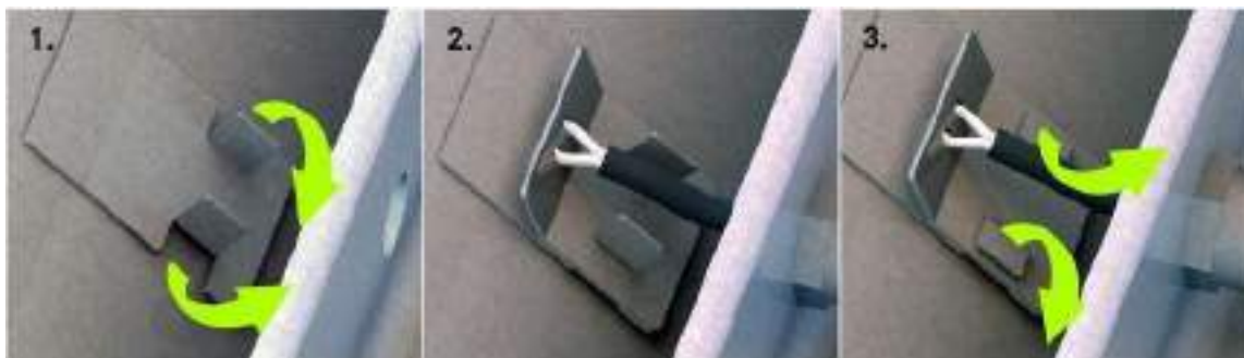
Рис. 39 – Установка индикатора открытия VMP – тип G1
