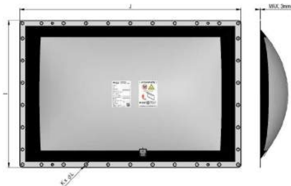
Рис. 7 – Размеры фланцевой части прямоугольных VMP (тип D)
