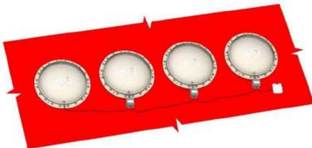
Рис. 53 – Подключение нескольких индикаторов открытия VMP (тип SU или D)
