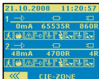
0 mA и 48 mA – действительное питающее напряжение в детекторном контуре 1 и 2
